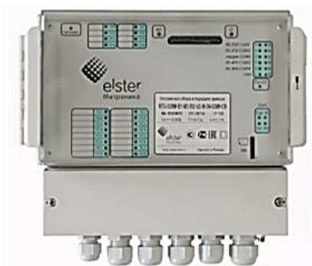
Рис. 4. УСПД (концентратор) – устройство сбора и передачи данных
