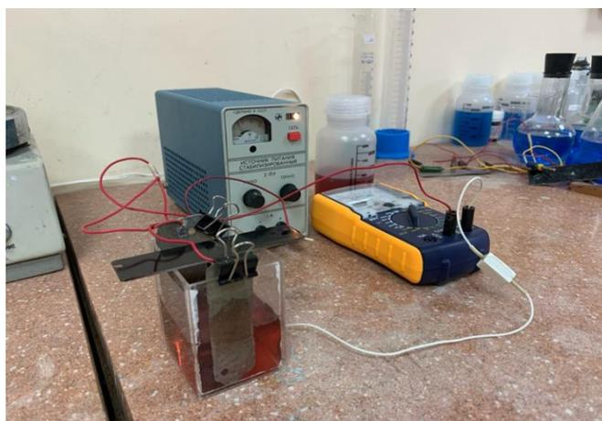
Рис. 1. Установка для нанесения покрытия кобальтом
