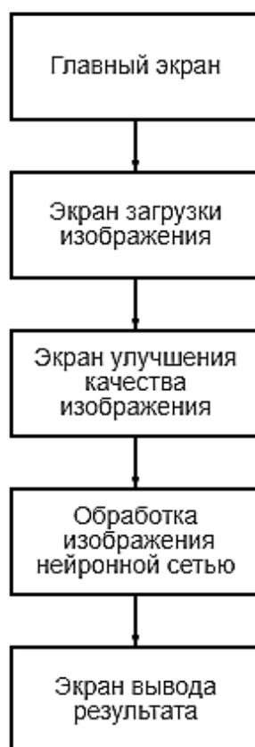
Рис. 1. Взаимосвязь элементов интерфейса системы улучшения качества изображений на мобильной платформе Android
