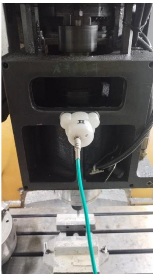
Рис. 1. Закрепление датчика на фрезерном обрабатывающем центре VTM9L
