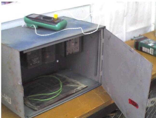
Рис. 1. Лабораторная установка с фольговым нагревателем
