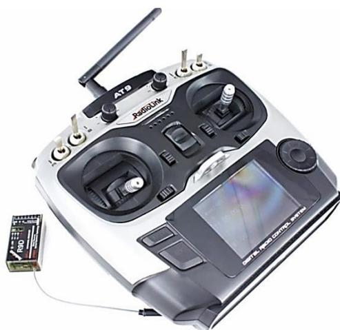
Рис. 2. Система дистанционного управления (2,4 ГГц)
