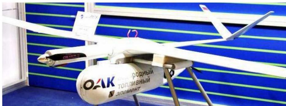
Рис. 3. Беспилотный аппарат «Инспектор-402»
