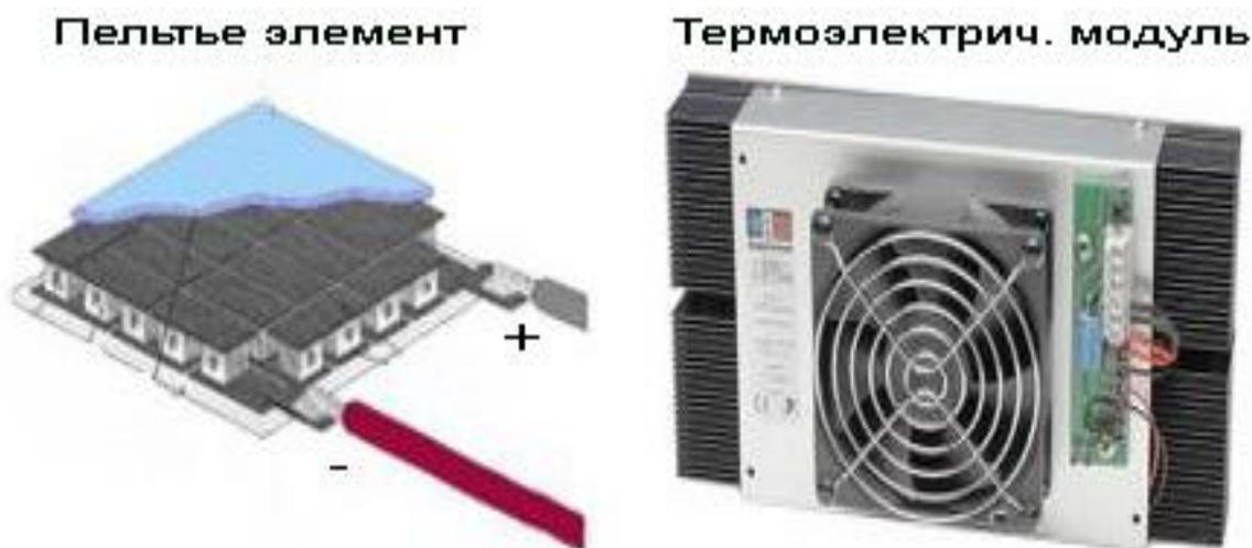
Рис. 2. Обеспечение температурных режимов чип-компонентов с использованием Пельтье-элементов
