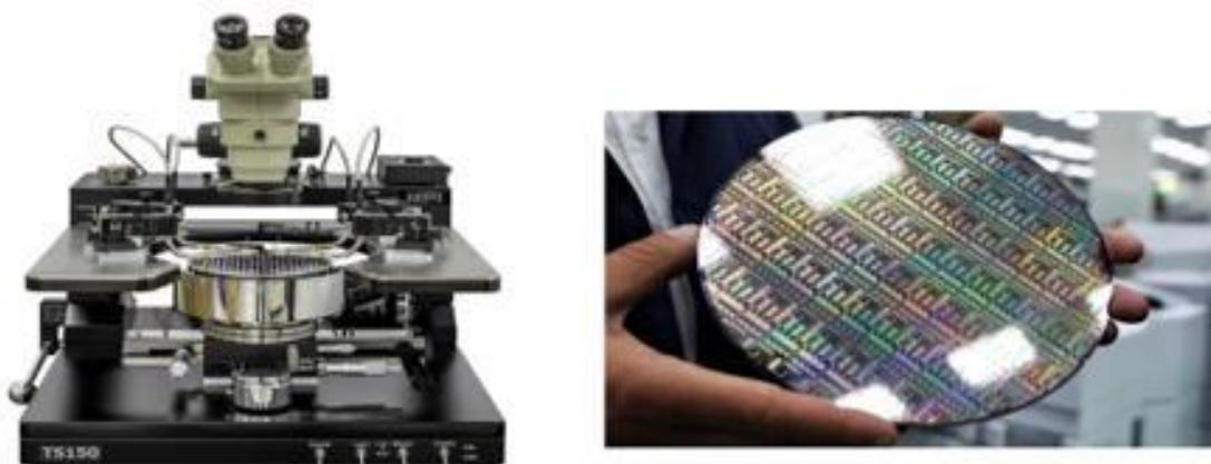
Рис. 1. Зондовый контроль чип-компонентов
