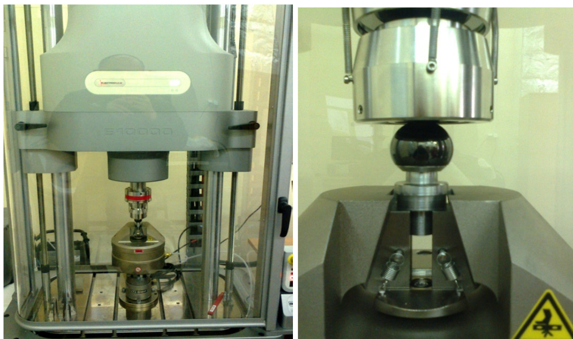
Рис. 3. Установка ElectroPuls E10000 для испытания крутящего момента по ГОСТ Р 52640–2006
