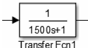
Рис. 4. Передаточная функция влажности
