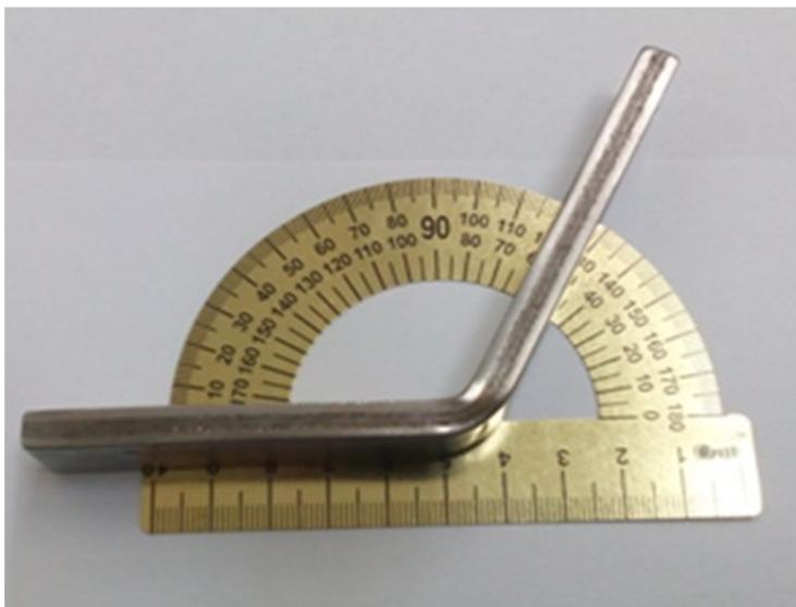
Рис. 9. Испытания на изгиб до заданного угла
